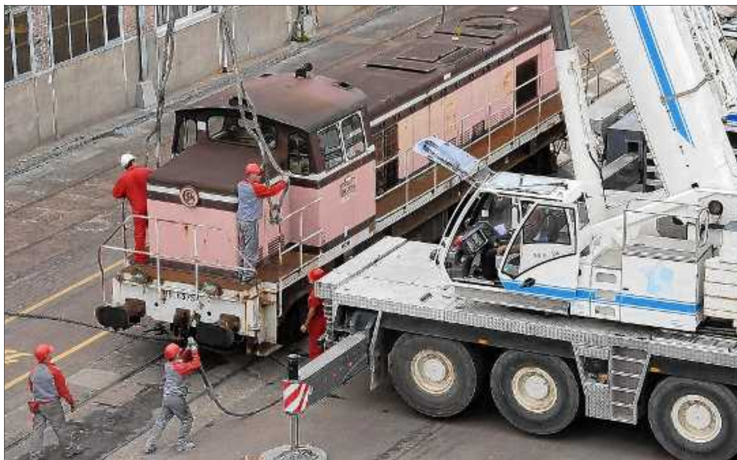
La loco BB 63500 a emprunté la voie ferrée jusqu'au site des usines chimiques de Thann avant d'être chargée sur une remorque pour être conduite, par la route, jusqu'à la gare de Burnhaupt. Photo A.V.
