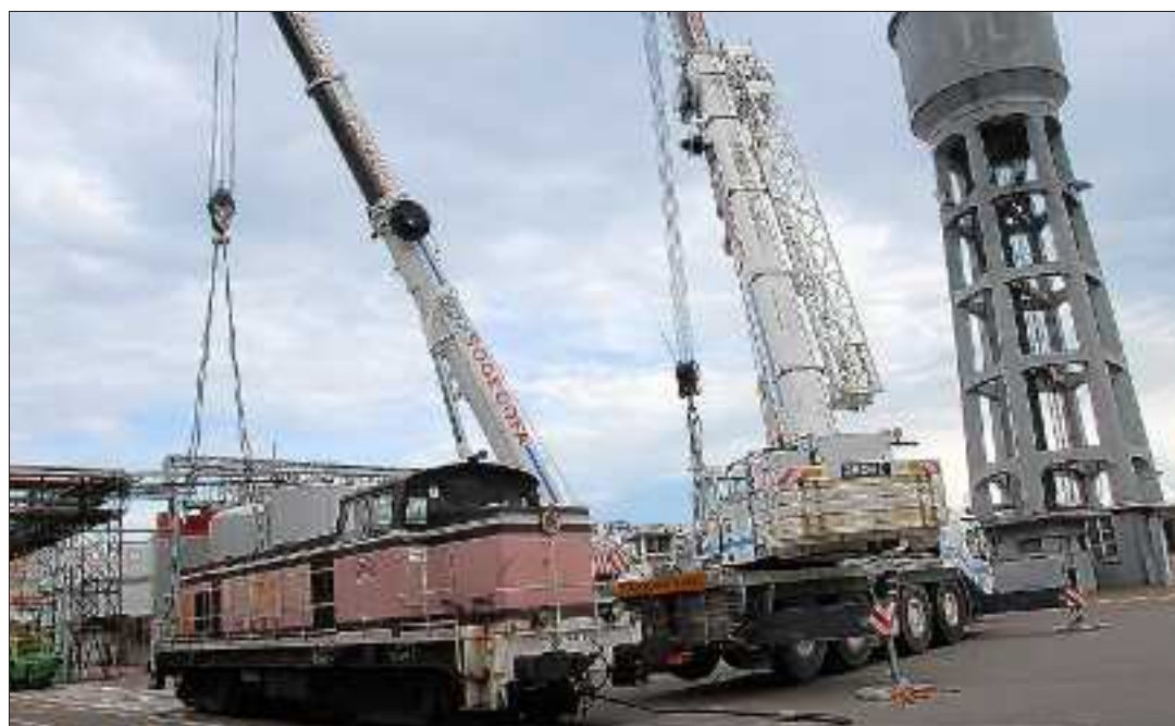
La locomotive, arrivée par rail sur le site des usines chimiques, a été soulevée par deux grues puis déposée sur un porte-char.
